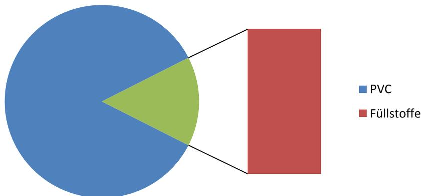
Einerseits dienen die Additive als Verarbeitungshilfen wie z.B. Thermostabilisatoren und Gleitmittel und andererseits haben sie eine funktionelle Komponente wie z.B. UV-Schutz und zur Anpassung der mechanischen Eigenschaften. Die eingesetzten Pigmente dienen der Farbgebung. Kreide dient in der Regel als Füllstoff und als funktionelle Komponente.
